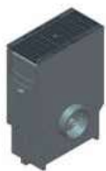
sumidero con reja GUGI malla 20/30, de fundición dúctil cl. C 250
