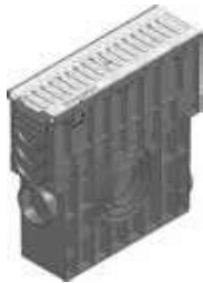
Sumideros con cestillo de lodo PE y rejilla pasarela SW 80/10, clase A 15, fija
