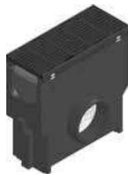
Sumideros con cestillo de lodo galvanizado y rejilla de fundición dúctil longitudinal, KTL, clase C 250, fija
