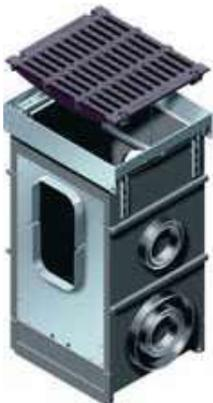
Sumidero con sistema de fijación SIDE-LOCK con carcasa angular galvanizada y sin pernos, rejilla de fundición dúctil con capacidad de carga F 900 y posibilidad de conexión de tubería de dos caras. Aplicable para intersección de tamaño nominal variable en cualquier posición de la sección de canal. También son posibles construcciones de varias partes.
